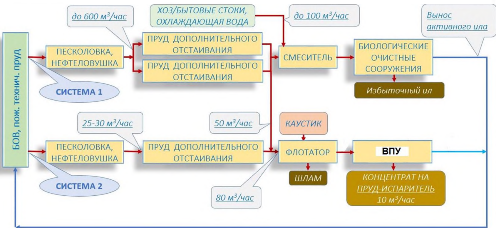
Рисунок 1.11. Планована принципова схема очисних споруд з використанням ВПУ
