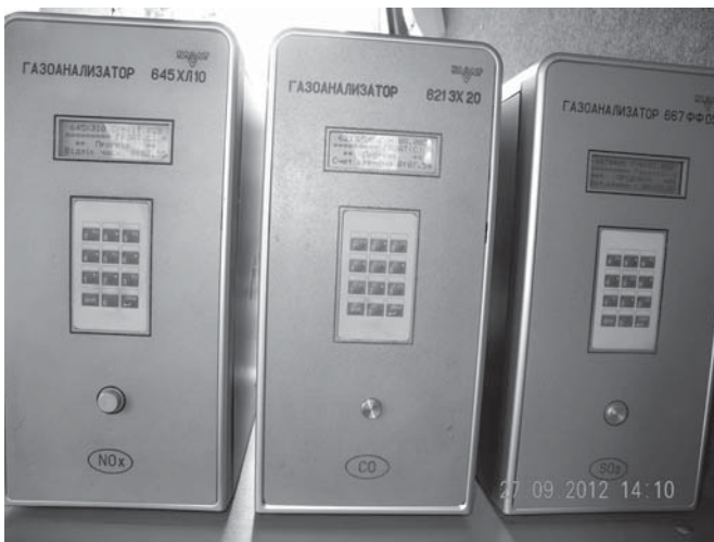
За допомогою стаціонарних газоаналізаторів проводяться виміри масових концентрацій газових забруднювачів
